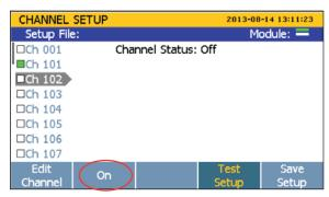
Drücken Sie die Software-Taste **Edit Channel**, und stellen Sie **Function** to Thermocouple, Thermistor oder PRT ein. Wählen Sie anhand der ausgewählten Funktion die entsprechenden Parameter aus. Konfigurieren Sie weitere Kanäle. Drücken Sie nach Abschluss **Back**.
